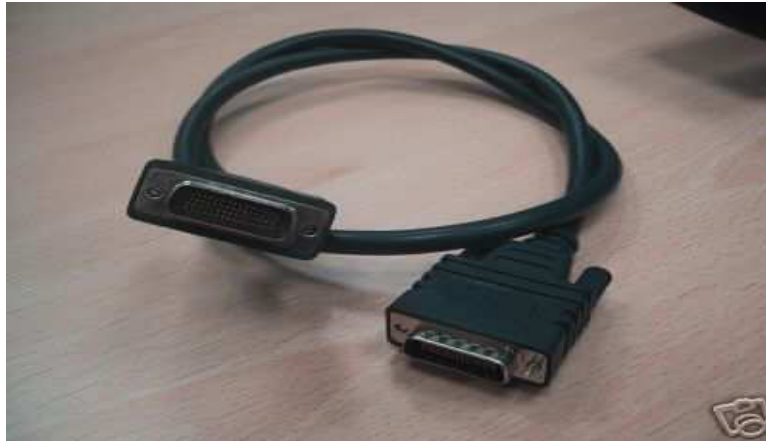
crossover DTE/DCE cable
